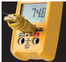
Thermoelement vom Typ K zum direkten Einstecken in das Messgerät
