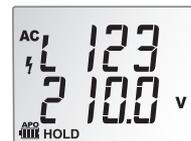
Per cambiare la direzione è sufficiente scambiare fra loro due linee qualsiasi. Ciò può essere verificato eseguendo nuovamente il test.
