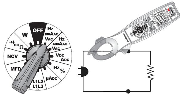
L'intensité CA (ACA), la fréquence (Hz) dans les pinces et le courant Inrush ACA sont mesurés avec les positions VCA / 100 ACA / Hz or VCA / 600 ACA / Hz présentées ci-dessus.
