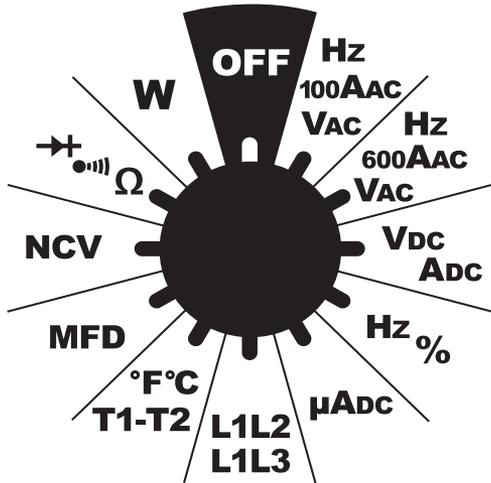
Le SC680 intègre les paramètres de mesure indispensables pour les professionnels de la climatisation (CVCR). Sélectionnez le paramètre que vous souhaitez mesurer avec le cadran de sélection rotatif.
